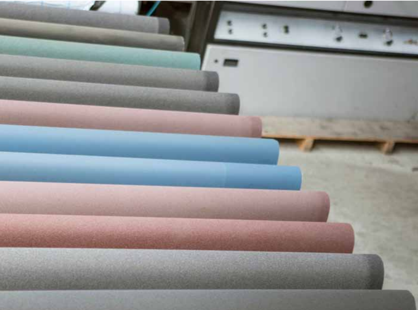
RVS platen worden geslepen van grof tot fijn
